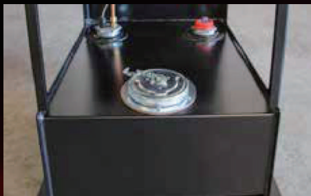
減油監視フロート付き燃料タンク
